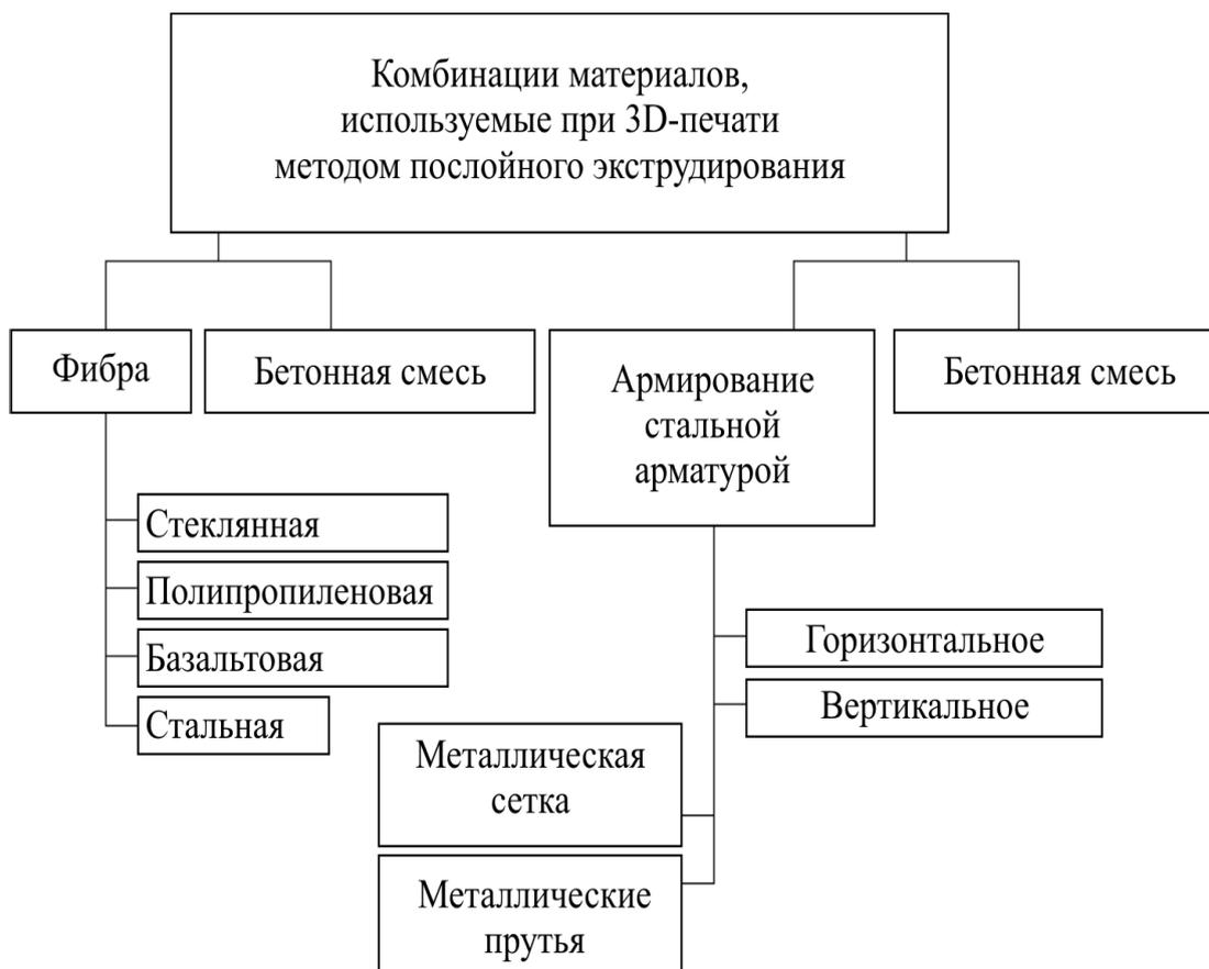
Рис. 4. Материалы, используемые при послойном экструдировании
