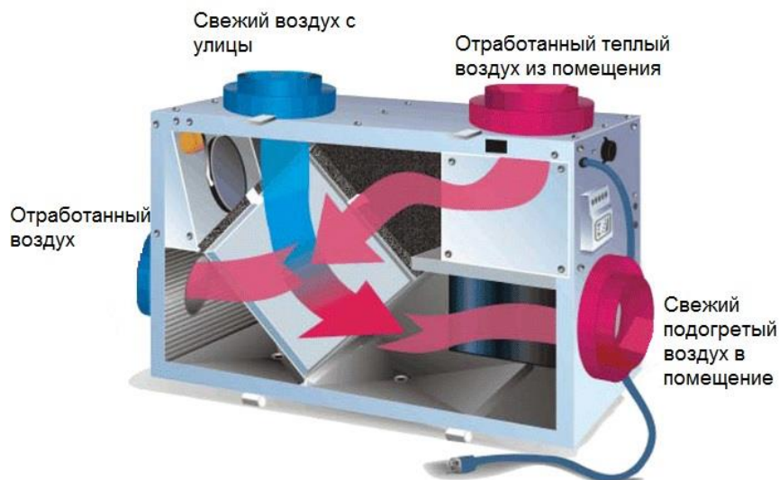
Рисунок 3.Схема работы рекуператора
