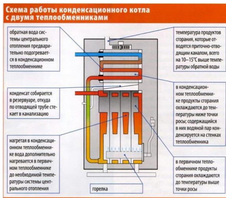
Рисунок 3 Схема работы конденсационного котла с двумя теплообменниками
