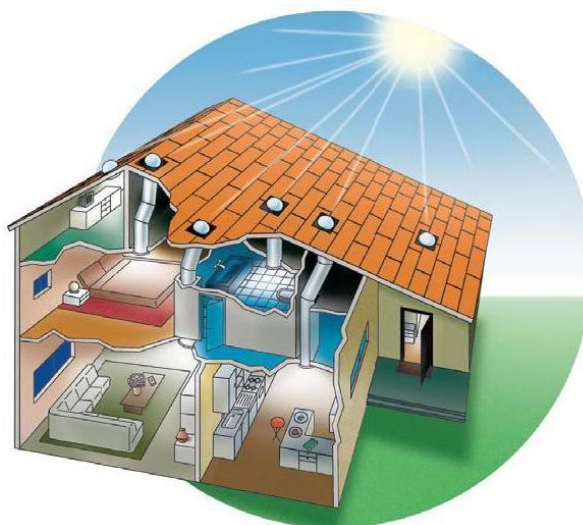
Рисунок 4. Схема крыши здания с установкой солнечных труб
