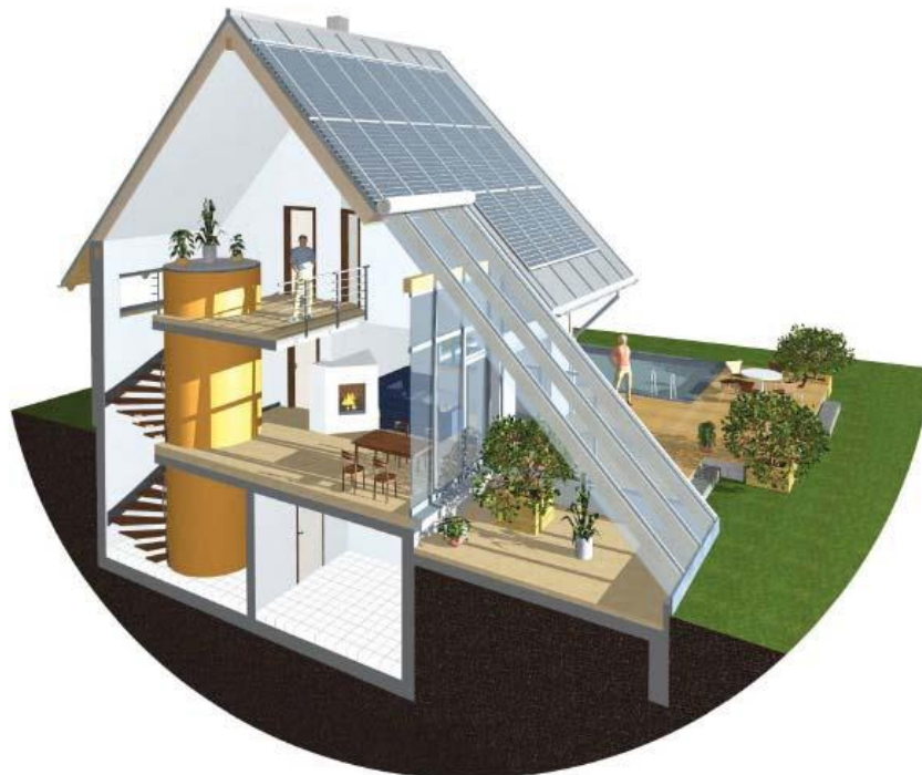
Рисунок 2. Схема рационального расположения помещений в доме в энергосберегающем доме.
