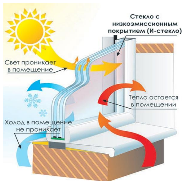
Рисунок 2.Схема устройства селективных стекол
